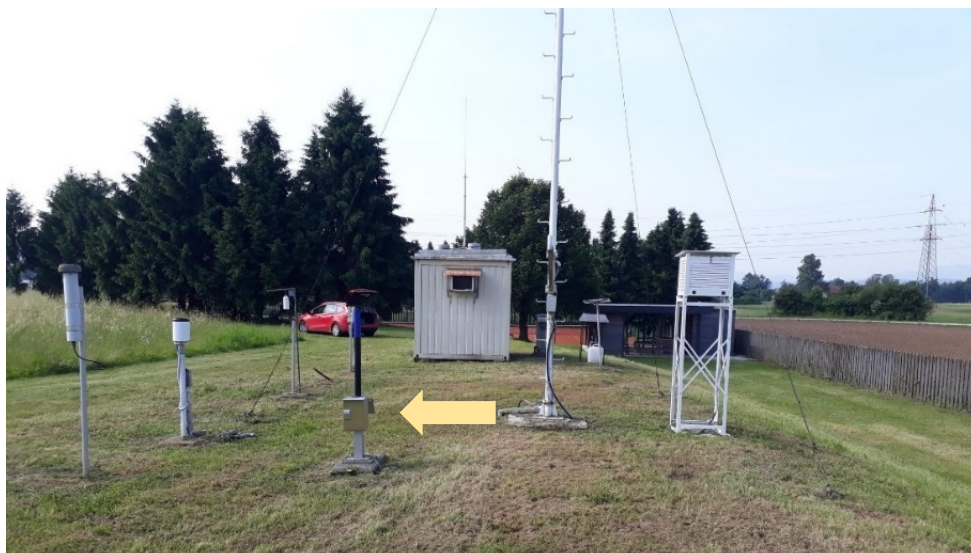
Slika 19: Testno delovanje merilnika Envinet Mira na lokaciji Ljubljana Brinje
