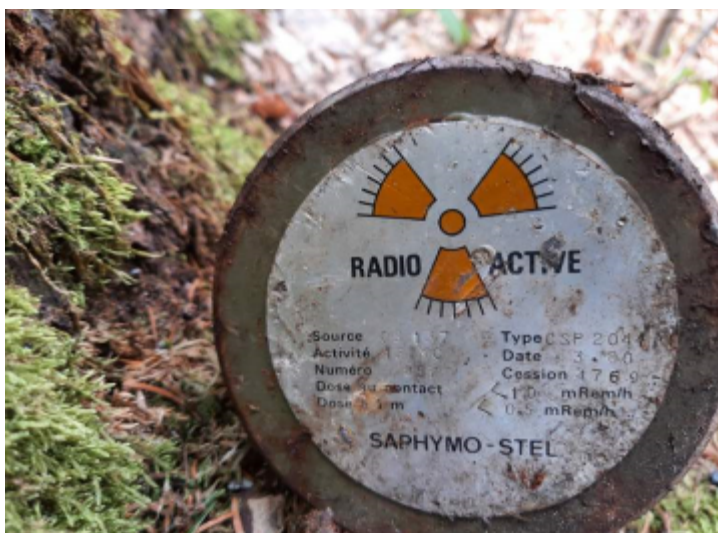
Slika 16: Industrijski vir s ^{137}\text{Cs} iz leta 1980, najden na ekološkem otoku na Vojskem (foto: ZVD, d. o. o.)
