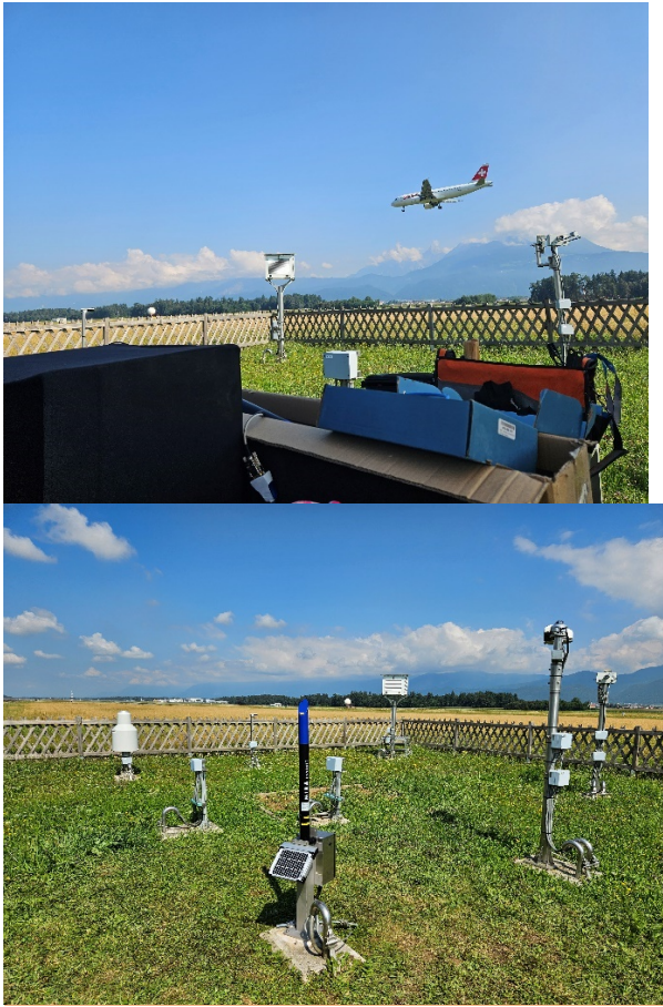
Slika 20: Zamenjava starega merilnika MFM z novim merilnikom hitrosti doze Envinet Mira na merilnem mestu Brnik
