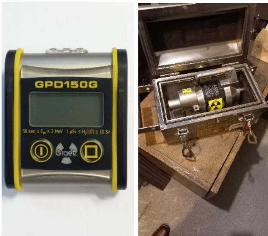
Slika 15: Elektronski osebni dozimeter v industrijski radiografiji (levo); primer vsebnika (desno) (foto: Inšpekcija URSJV)
