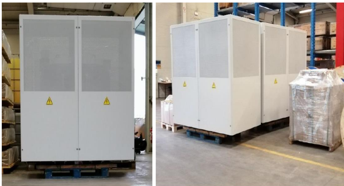
Rekonstrukcija in nadgradnja čistilne naprave v Žitomirju (Ukrajina). Kolektor ETRA Slovenija in transformatorji USTS 630-10/0,4. (Foto: CMSR)
